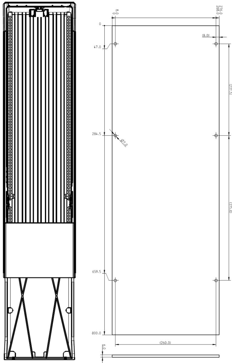
*Links:* Repräsentative Abbildung einer Rückwand eines leeren Schrankes mit der Lochleiste zur Befestigung der Montageplatte. *Rechts:* Repräsentative Abbildung einer Montageplatte.
