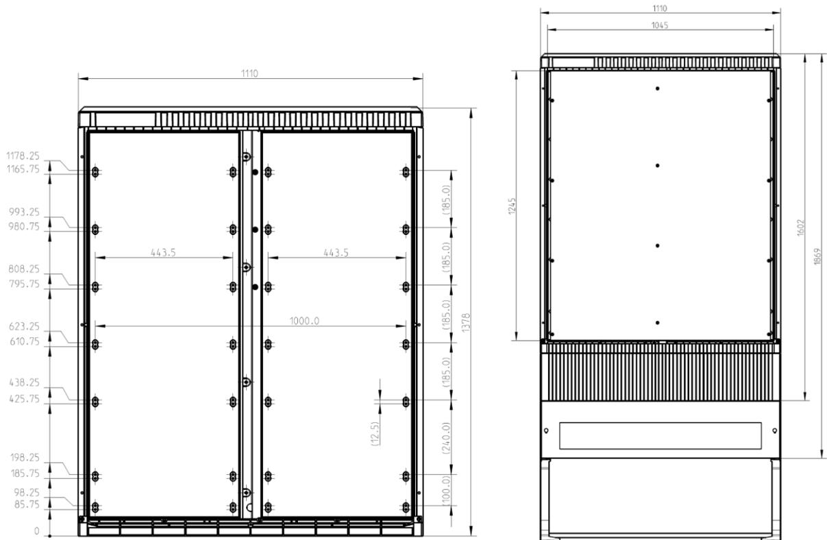
*Links:* Repräsentative Abbildung eines leeren Schrankes mit der Positionierung der Dome für die Befestigung der Montageplatte. *Rechts:* Repräsentative Abbildung eines Gehäuses mit der Montageplatte im Inneren.
