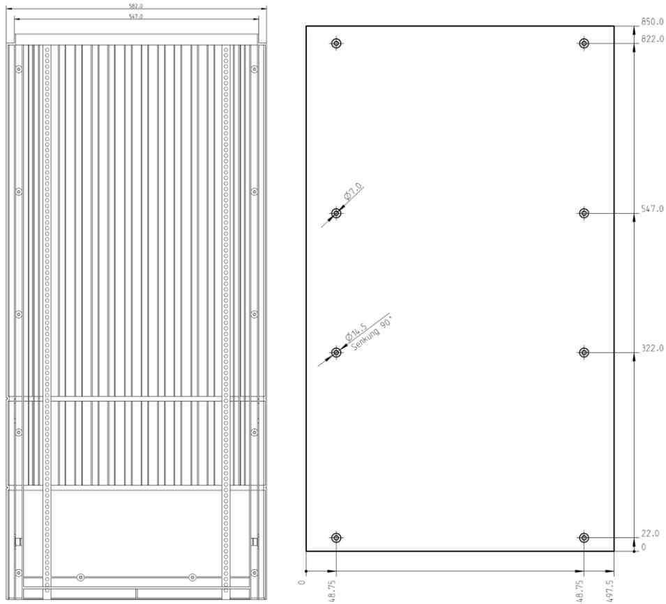
*Links:* Repräsentative Abbildung einer Rückwand eines leeren Schrank mit der Lochleiste zur Befestigung der Montageplatte. *Rechts:* Repräsentative Abbildung einer Montageplatte.
